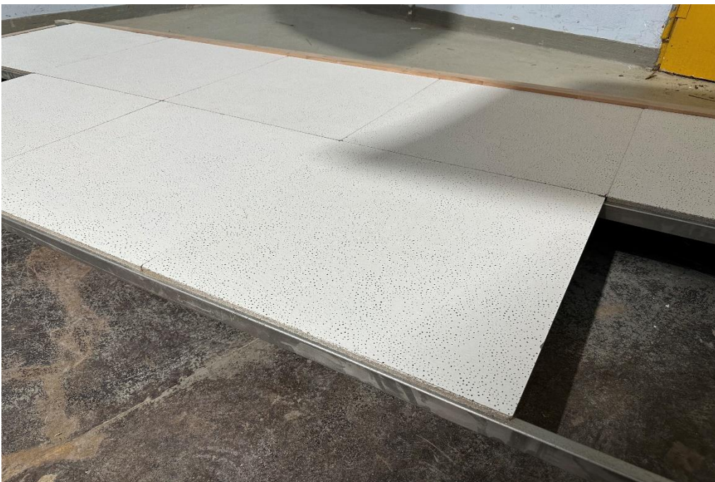
Detailansicht Prüfobjekt un-/beschichtete Akustikdecke in 20 cm hoher Umrandung aus Holz
