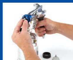
1 Entfernen Sie die Luftkappe und die Düse
